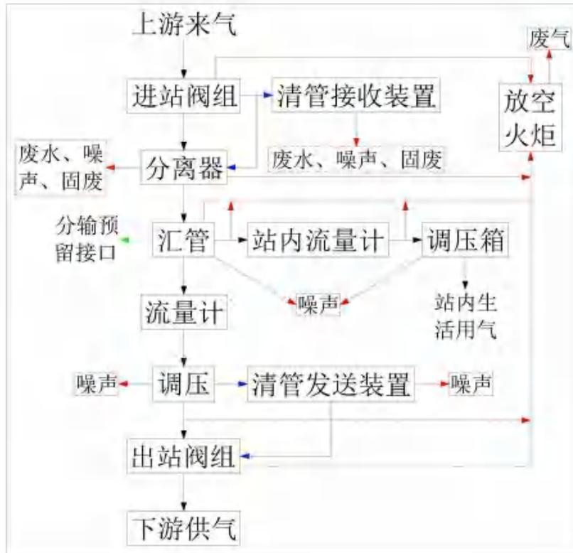
图 2.4-1 大磏站工艺流程及产污节点图
