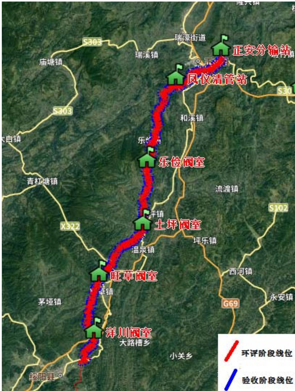
图 3.4-1 工程实际建设与环评阶段线位对比图
