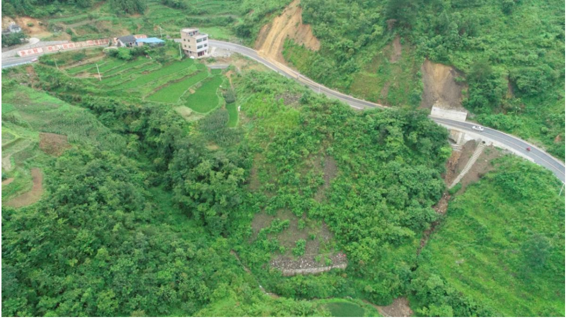
7#弃渣场水土保持治理效果图（挡土墙）
