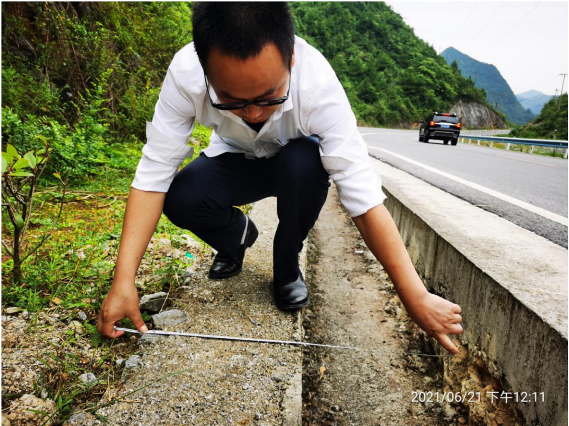
监测小组人员在现场调查项目区排水沟尺寸情况
